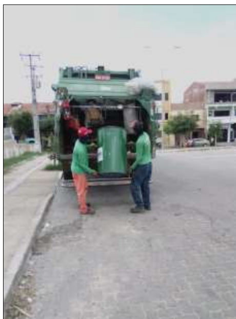
Figura 13 - Caminhão de coleta compactador (12m 3 ) realizando a coleta na região central
